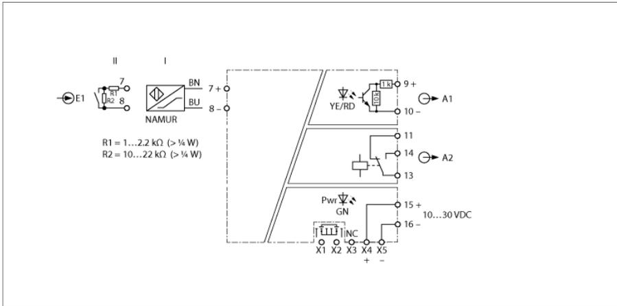
En el repetidor NAMUR IM12-DI03-1S-1NAM1R-PR/24V CC/CC se puede conectar sensores conforme a la norma EN 60947-5-6 (NAMUR) o contactos sin potencial. Esto puede instalarse dentro de la zona 2. El circuito de salida también está equipado con una salida de relé. El dispositivo se puede alimentar desde un puente de alimentación que también transmite una señal de falla colectiva. El dispositivo cumple los requisitos de la norma NE21.
