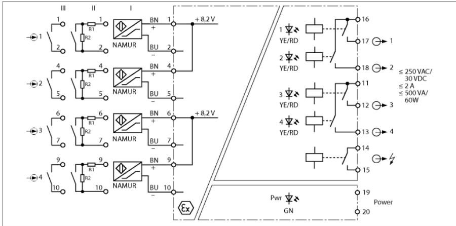
El amplificador separador de cuatro canales tipo IM1-451EX-R está equipado con circuitos de entrada con seguridad intrínseca.
