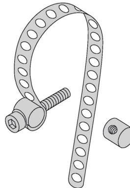
Montaje en cilindros redondos; diámetro del cilindro de 25...80 mm; material: metal A2 1.4301 (AISI 304), dos pernos de fijación (material: metal CuZn, como alternativa metal A2 1.4301 / AISI 304) tornillo del cilindro M3 x 20 (DIN 912-A20)
