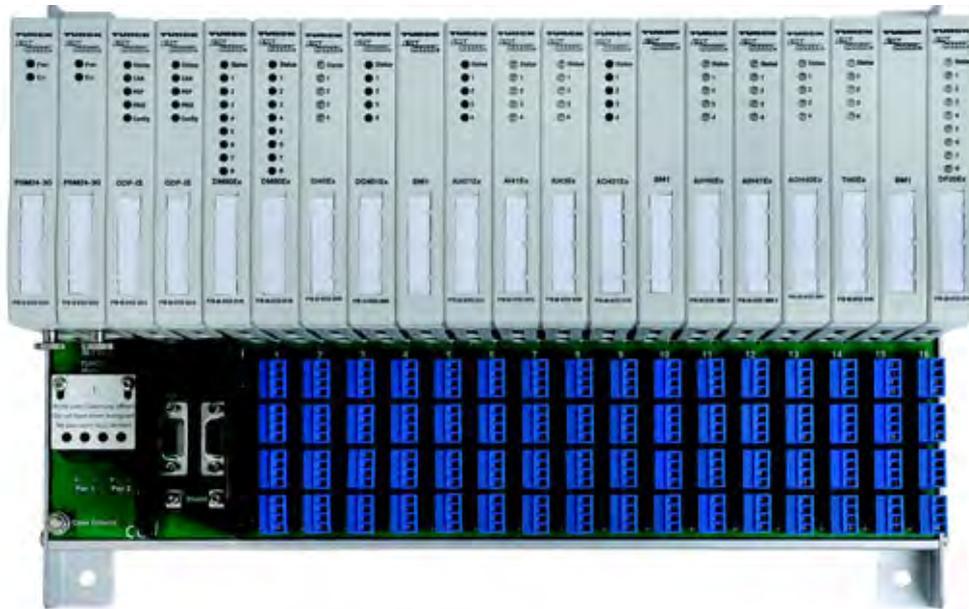
excom® ist ein Remote-I/O-System für PROFIBUS-DP zum Einsatz in explosionsgefährdeten Bereichen. Das System verfügt über busfähige, dezentrale Ein-/Ausgangsmodule in Schutzart IP20 zum Anschluss von binären und analogen eigensicheren Feldgeräten. Die Ex-Schutzart des Systems erlaubt den Einsatz in den Zonen 1 und 2 (nach EN 60079-10) und 21 und 22 (nach EN 61241-10). Die Feldstromkreise sind für die Zonen 0, 1 und 20 und 21 zugelassen.
