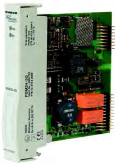
Das Versorgungsmodul PSM24-3G dient der Versorgung des excom®-Systems bis zum Vollausbau. Das Versorgungsmodul ist in Modulbauform ausgeführt und kann in Zone 2 eingesetzt werden. Die Versorgungsspannung beträgt 19,5...32 VDC beim PSM24-3G. Der Anschluss der externen Versorgung erfolgt über Ex-e Klemmen auf dem Modulträger.
