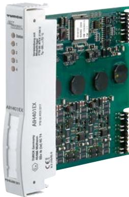
Abb. 1: Analoges Eingangsmodul AIH401Ex
