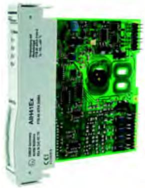
Das analoge Eingangsmodul AIH41Ex dient zum Anschluss von eigensicheren 4-Leiter-Messumformern (passiver Eingang = nicht speisend/Geber aktiv).
