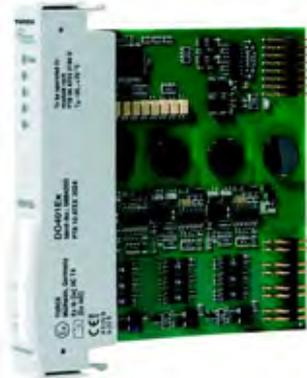
Das digitale Ausgangsmodul DO401Ex dient zum Anschluss von eigensicheren Aktuatoren wie Ventile (mit den beiden Status „auf“ und „zu“) oder Anzeigeelemente.
