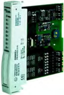
Das digitale Ein-/Ausgangsmodul DM80Ex dient zum Anschluss von NAMUR-Sensoren (EN 60947-5-6) und Aktuatoren. Werden mechanische Kontakte angeschlossen, ist bei aktivierter Drahtbruch- oder Kurzschlussüberwachung eine entsprechende Widerstandsbeschaltung (WM1, Ident-Nr. 0912101) vorzunehmen.
