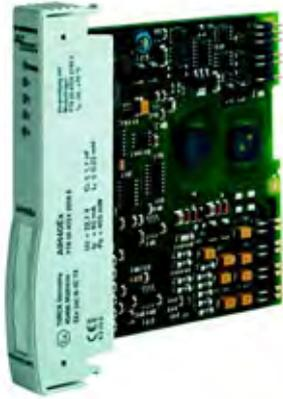
Das analoge Eingangsmodul AIH40Ex dient zum Anschluss von eigensicheren 2-Leiter-Messumformern (aktiver Eingang = speisend/Geber passiv). Das Modul hat die Schutzart Ex ib IIC und kann daher in Verbindung mit *excom*® in Zone 1 eingesetzt werden. Die Zündschutzart der Eingänge ist Ex ia IIC.
