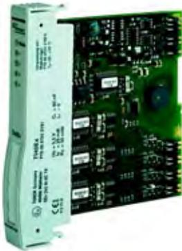
Das Temperaturmodul TI40Ex dient zum Anschluss von 2-, 3- und 4-Leiter-Temperaturwiderständen der Typen Pt100, Pt200, Pt500, Pt1000, Ni100 und Cu100 sowie zum Anschluss von Thermoelementen der Typen B, E, D, J, K, L, N, R, S, T und U.
