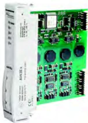
Das analoge Eingangsmodul AI43Ex dient zum Anschluss von Potenziometern in 3- oder 4-Leiter-Technik. Bei der Verwendung von 3-Leiter-Potenzio­metern muss an den Ex i-Anschlussklemmen am Modulträger eine Brücke gesetzt werden. Widerstandsmessungen, also die Auswertung von Potenziometern mit 2-Leiteranschluss, sind nicht möglich.
