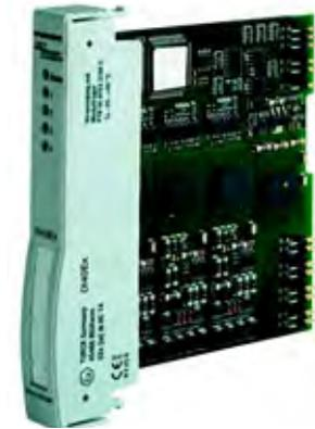
Das digitale Eingangsmodul DI40Ex dient zum Anschluss von maximal 4 Sensoren nach NAMUR (EN 60947-5-6) oder mechanischen Kontakten. Werden mechanische Kontakte angeschlossen, ist bei aktivierter Drahtbruch- oder Kurzschlussüberwachung eine entsprechende Widerstandsbeschaltung (WM1, Ident-Nr. 0912101) vorzunehmen.
